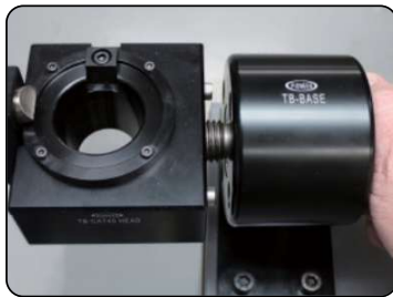
1. TBベースの裏側にあるノブを回してTBベースへTBヘッドを取り付けます。
