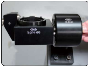
4. TBヘッドをご希望の位置へ回します。90度毎に固定できます。
