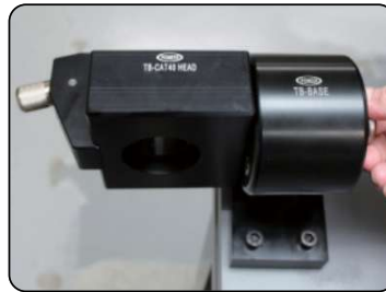
5. TBヘッドを固定後、ツールホルダーを入れると、スナップピンが自動的にパチンとはまります。
