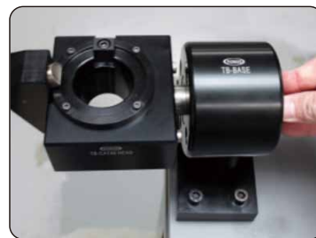
3. TBベースからTBヘッドのオートロックを解除するためにノブを押し入れます。
