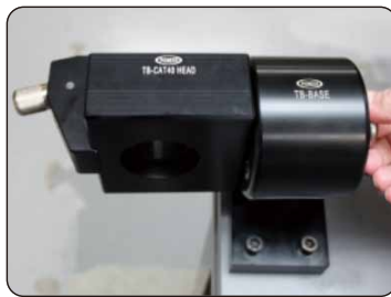
5. TBヘッドを固定後、ツールホルダーを入れると、スナップピンが自動的にパチンとはまります。
