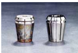
(4ヶ月間の経過テスト) 左: サビ止め処理なしの場合 右: サビ止め処理ありの場合
