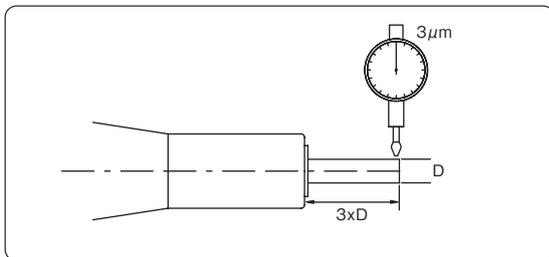
ツールノーズ3D先端で3µm以内の振れ精度
